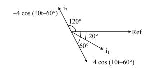
$i_2 \text{ lags } i_1 \text{ by} = 360^\circ - 140^\circ = 220^\circ$
